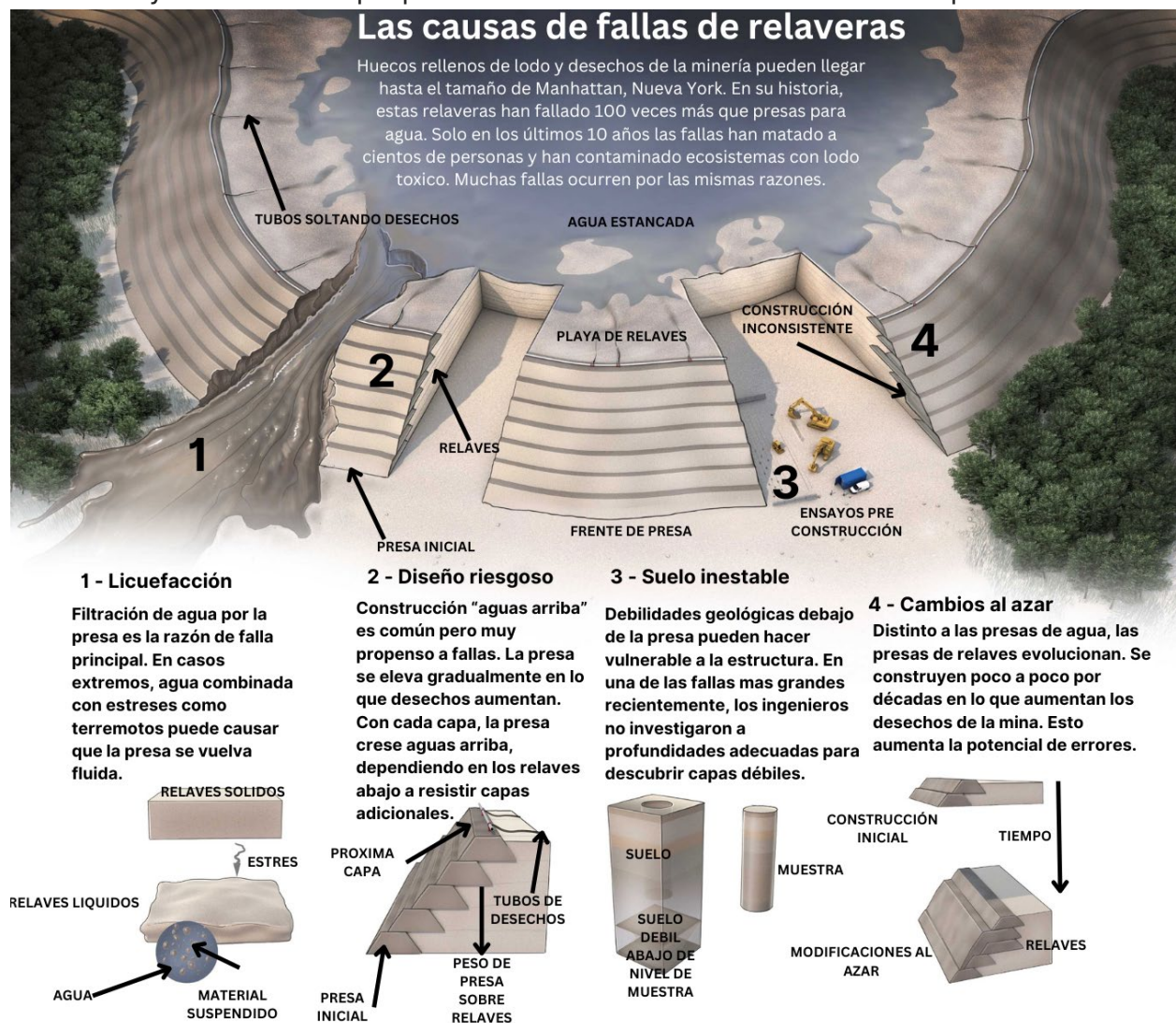
Figura 1. Las causas de fallas de relaveras mineras.
